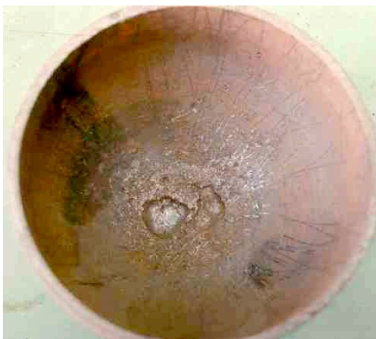
Lochfrass im Boden einer Taucherflasche
